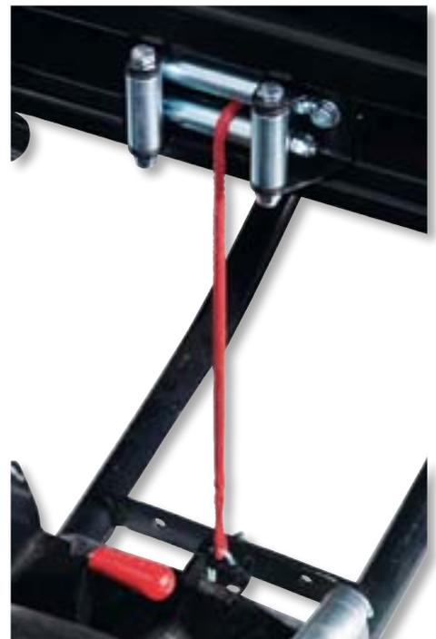
**SYNTHETIC WINCH CABLE FOR PLOUGH**
